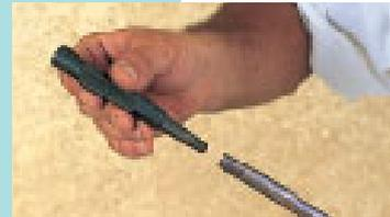
**2. Enfiler le mandrin au bon diamètre dans le tube qui a été recuit.**
