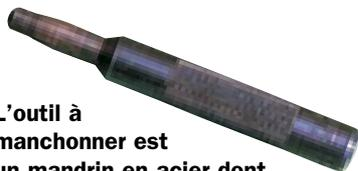
**L'outil à manchonner est un mandrin en acier dont le bout s'élargit progressivement d'un diamètre de tube à un autre. Il existe un mandrin pour chaque diamètre de tube.**
